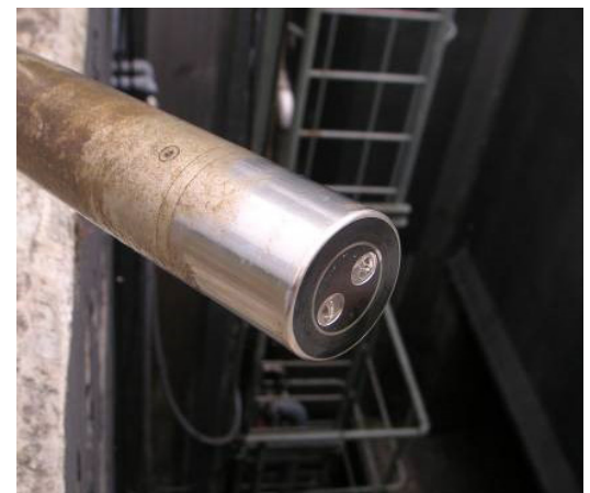
Die Messfenster der VisoTurb® 700 IQ sind auch nach mehreren Wochen Messeinsatz sauber.
